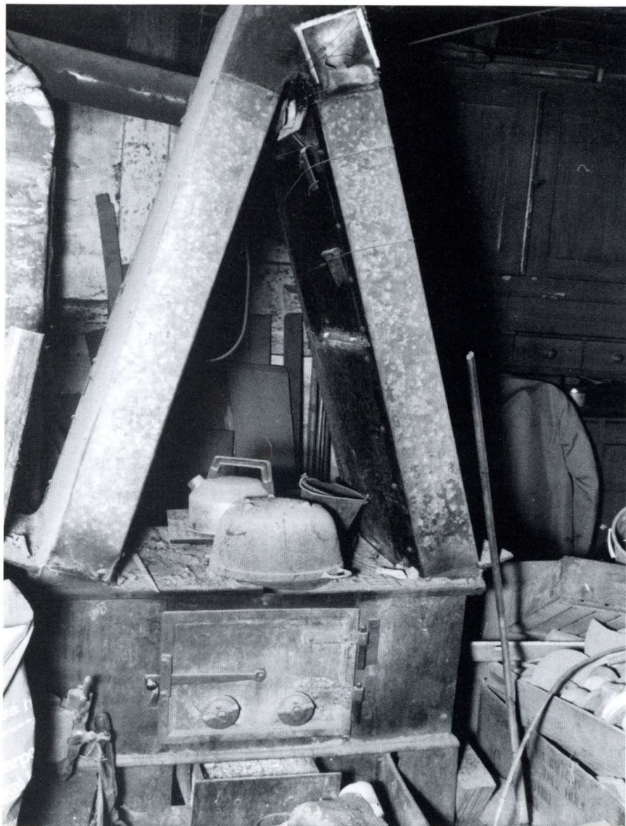
Den gamle ovn på værkstedet. Den har været der "altid" og vi brugte den bl. a. til at opvarme lange stykker træ, der skulle limes sammen, fortæller Ernst Brandt.
