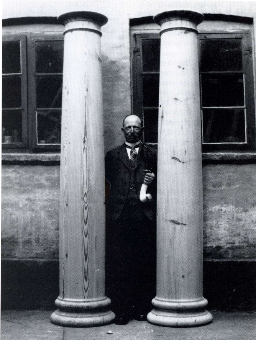
En stolt drejermester, Frederik Brandt, med et stykke færdigt arbejde: To fyrretræssøjler til Hotel Prindsen. Omtalt i teksten på side 13.
